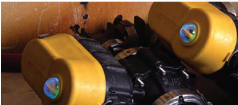
Un voyant LED fournit des informations sur les performances des soupapes, avec une lumière bleue pour indiquer qu'elles sont sous tension et une lumière jaune si les fusibles sont grillés. Pour la vérification d'ouverture / de fermeture (en option), le voyant LED est vert et rouge, respectivement. En option également, la soupape EVX signale la température, la tension et le nombre de cycles.
