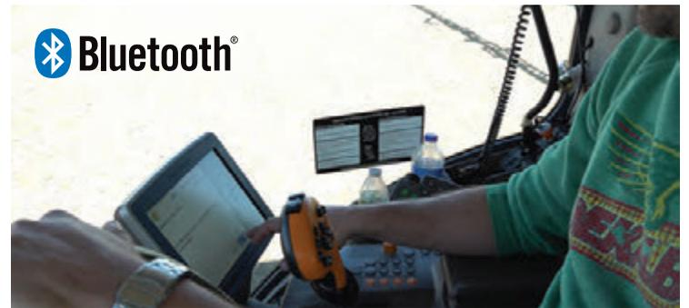
L'EVX a recours aux tout derniers protocoles de communication, allant des commandes directes à bus CAN / ISO et à la technologie sans fil Bluetooth<sup>®</sup>. Ses options de diagnostic mesurent et signalent la tension, la température et le nombre de cycles pour indiquer toute situation préoccupante avant qu'elle ne devienne problématique.
