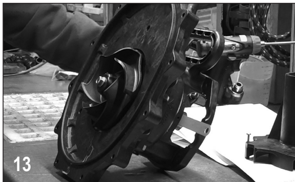
13 Remove impeller bolt.
