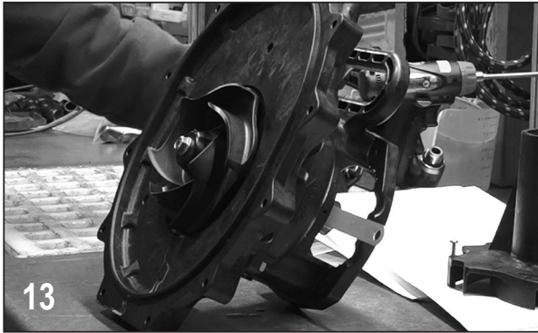
13 Remove impeller bolt.
